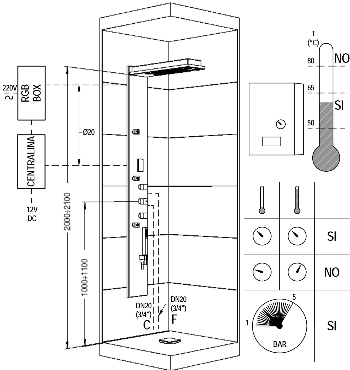
Per il corretto funzionamento è consigliabile una pressione dinamica di almeno 2.5 bar ed una portata d'acqua di 22 lt/min. Scarico consigliato foro Ø90
