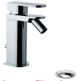
**Per installatore: Al fine di garantire la durata del prodotto installare rubinetti sottolavabo con filtro da pulire periodicamente. Effettuare risciacquo delle tubazioni prima di installare il prodotto (PUNTO 1) Eventuali residui se finissero all'interno della cartuccia potrebbero causare il danneggiamento**
