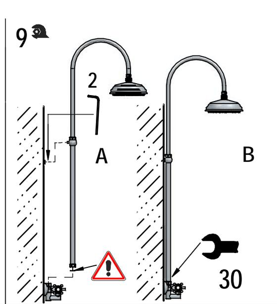
**! SOSTITUZIONE VITONE/ VALVE REPLACEMENT**
