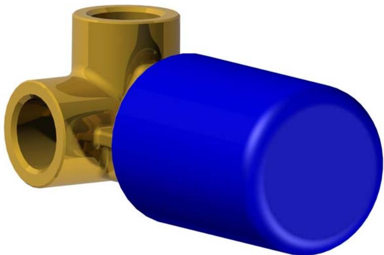
Per installatore: Al fine di garantire la durata del prodotto installare rubinetti con filtro da pulire periodicamente. Effettuare risciacquo delle tubazioni prima di installare il prodotto (PUNTO 1). Eventuali residui se finissero all'interno della cartuccia potrebbero causarne il danneggiamento.
