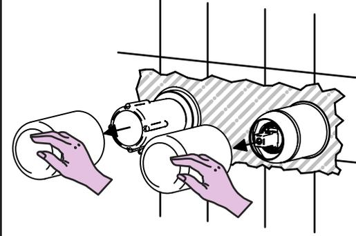
Per installatore: Al fine di garantire la durata del prodotto installare rubinetti con filtro da pulire periodicamente. Effettuare risciacquo delle tubazioni prima di installare il prodotto (PUNTO 1)
