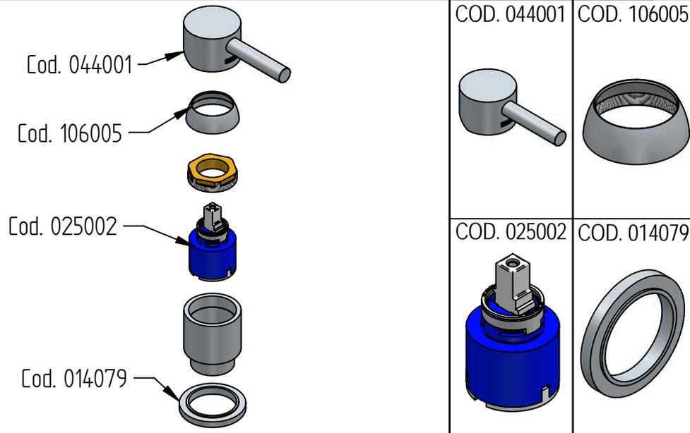
**Per installatore: Al fine di garantire la durata del prodotto installare rubinetti sottolavabo con filtro da pulire periodicamente. Effettuare risciacquo delle tubazioni prima di installare il prodotto (PUNTO 1)**
