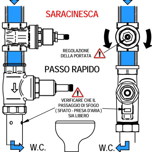
PER UNA CORRETTA INSTALLAZIONE DI UN PASSO RAPIDO SI DEVONO EQUILIBRARE LA PRESSIONE A MONTE (IMPIANTO) E QUELLA A VALLE (W.C.)
