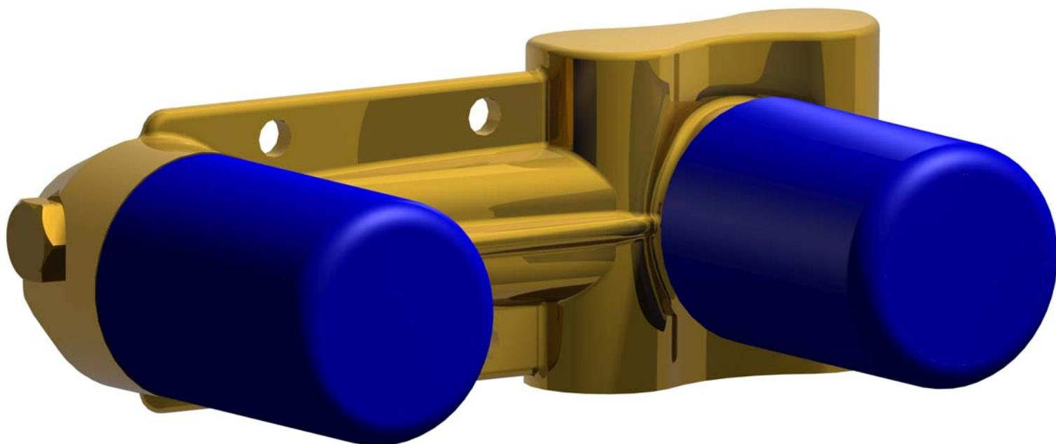
**Per installatore: Al fine di garantire la durata del prodotto installare rubinetti con filtro da pulire periodicamente. Effettuare risciacquo delle tubazioni prima di installare il prodotto (PUNTO 1). Eventuali residui se finissero all'interno della cartuccia potrebbero causarne il danneggiamento**
