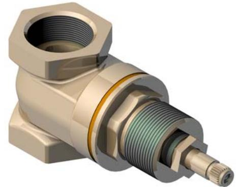
**Per installatore: Al fine di garantire la durata del prodotto installare rubinetti con filtro da pulire periodicamente. Effettuare risciacquo delle tubazioni prima di installare il prodotto (PUNTO 1) Eventuali residui se finissero all'interno della cartuccia potrebbero causarne il danneggiamento**
