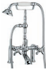
Art. 0701/4/C p. 298 Gruppo esterno per vasca forcella alta s/duplex completo e raccordi da 3/4" sul bordo Exposed bath group high cradle without shower kit to be fitted on bath rim 3/4" elbows
