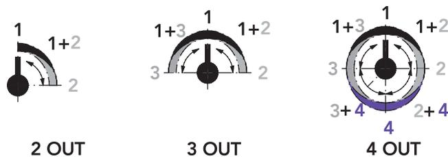
**SCHEMA FUNZIONAMENTO MISCELATORI TERMOSTATICI 2/3/4 USCITE**
