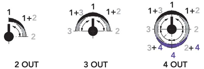
**SCHEMA FUNZIONAMENTO MISCELATORI TERMOSTATICI 2/3/4 USCITE**
