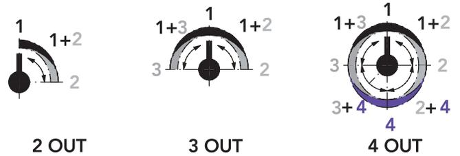
**SCHEMA FUNZIONAMENTO MISCELATORI TERMOSTATICI 2/3/4 USCITE**
