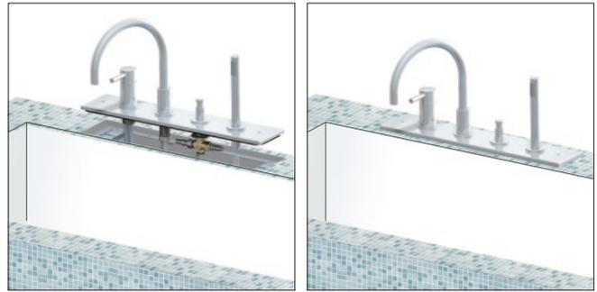
B - BORDO V-BOX CON PIASTRA RIVESTITA. OPTIONAL: SISTEMA DI PRE-INSTALLAZIONE (012/6)
