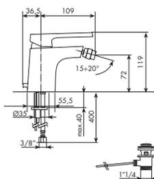
Spessore installazione max. 78 mm
