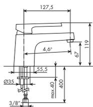
Spessore installazione max. 78 mm
