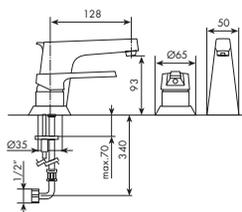
Spessore installazione max. 50 mm
