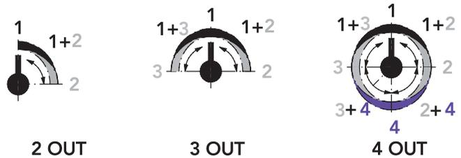
**SCHEMA FUNZIONAMENTO MISCELATORI TERMOSTATICI 2/3/4 USCITE**
