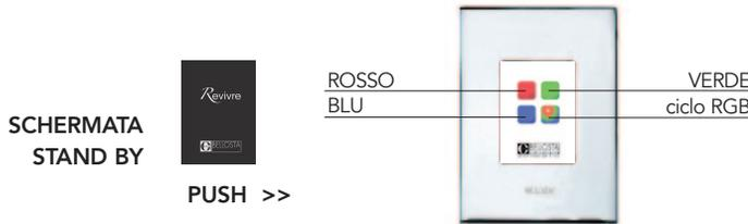
**MODALITÀ DI FUNZIONAMENTO ADOTTATA PER IL TOUCH SCREEN PER IL CONTROLLO DEI FARETTI RGB DEI SOFFIONI**
