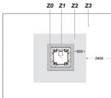
Volendo installare il comando LED (oggetto B, in figura) nella zona di sicurezza Z3, si può scegliere di escludere il dispositivo a tenuta, proposta da Bellosta Rubinetterie, in favore di un comando tradizionale, dotato almeno di un pulsante, con la placca di finitura in linea con le specifiche esigenze del cliente. Una soluzione concepita per fornire la massima scelta di forme, finiture e materiali.
