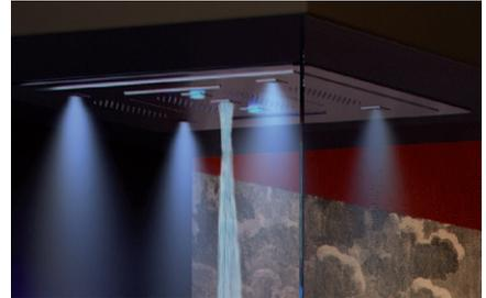
Per il corretto funzionamento è consigliabile una pressione dinamica di almeno 2.5 bar ed una portata d'acqua di 23 lt/min. Scarico consigliato foro Ø90.
