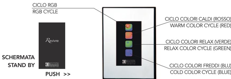
**MODALITÀ DI FUNZIONAMENTO ADOTTATA PER IL TOUCH SCREEN DI CONTROLLO ACQUA**
